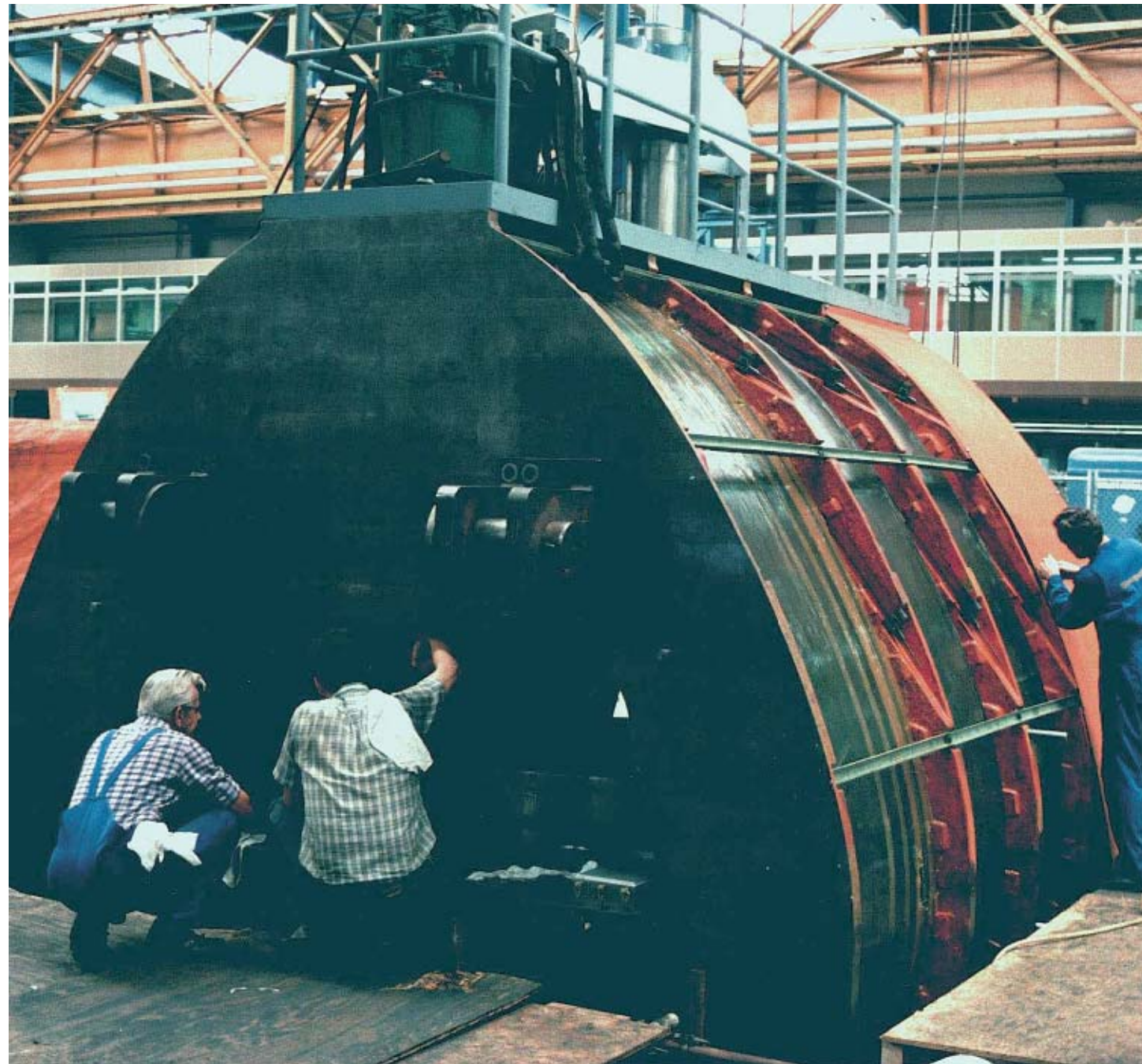
Wire-wound press frame. Press force 200,000 kN
